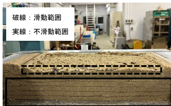
写真1 せん断後の断面
